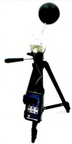
Рис. 3. Измеритель тепловой облученности ТКА-ИТО.
